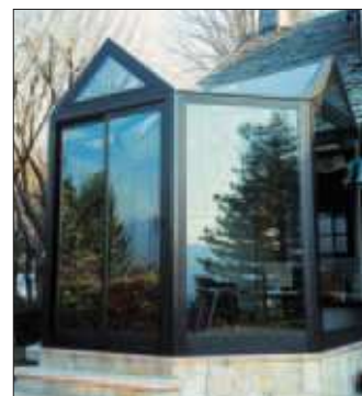
Esempi di verande utilizzate come protezione o tampone dell'ingresso per ridurre le dispersioni termiche.
